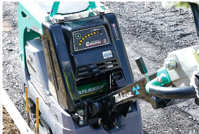
緑色と赤色のみ点灯:地盤不良や軟弱地盤の場合 緑色と赤色のみ点滅:断線等故障の場合
